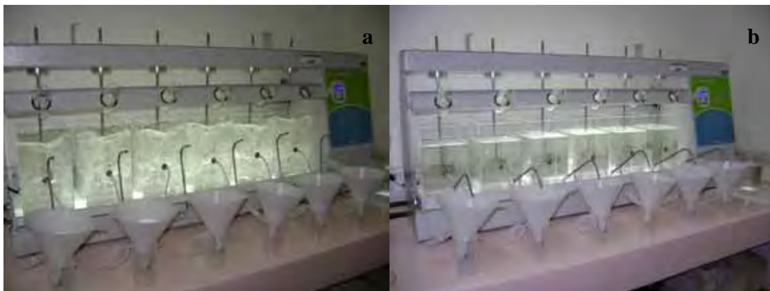
Figura 30: Ensaio em Jarreste (a), com detalhe da coleta simultânea de amostras (b)
