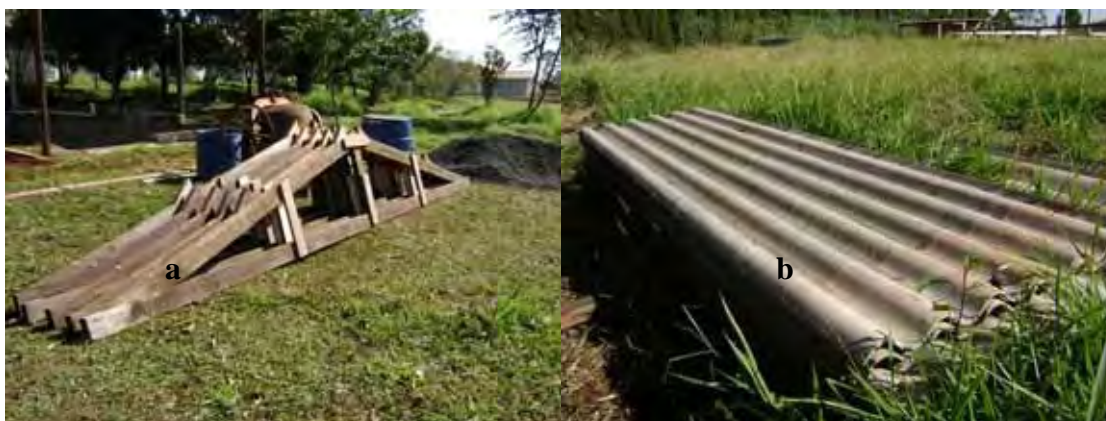
Figura 15: Tesouras de madeira (a) e telhas de fibrocimento (b), em 15/06/2011
