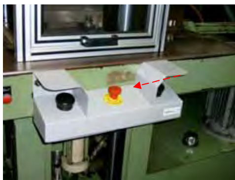
Figura 23 – Exemplos de botões de emergência geralmente utilizados em prensas.
