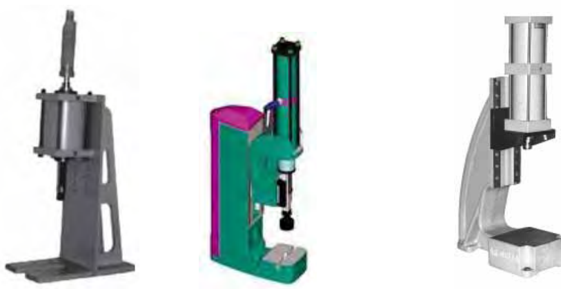
Figura 16 – Exemplos de prensas pneumáticas
