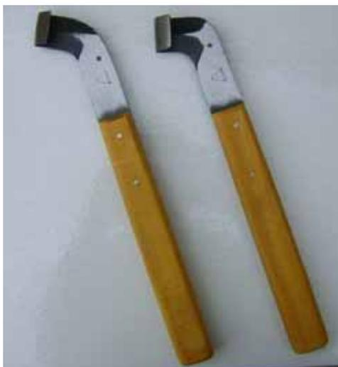
**Figura 1.2** – A *jebong*, faca utilizada para coleta do látex.
