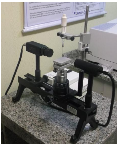
Figura 3.2.2 – Goniômetro da marca Ramé-Hart, modelo 100-00.
