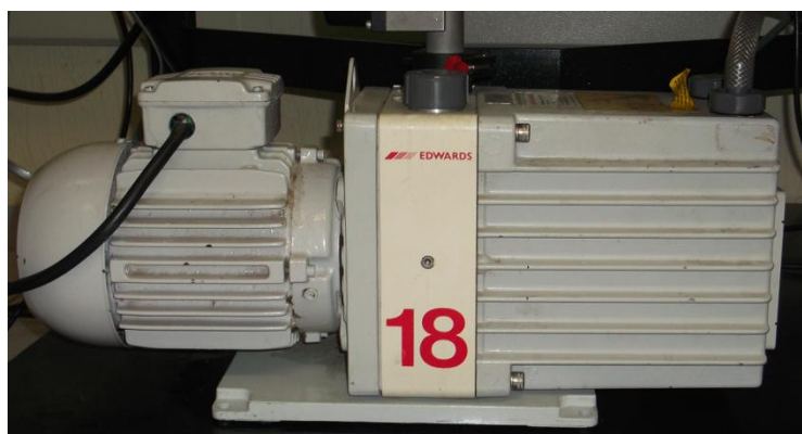
Figura 3.1.3 – Bomba de evacuação da marca Edwards, modelo E2M18
