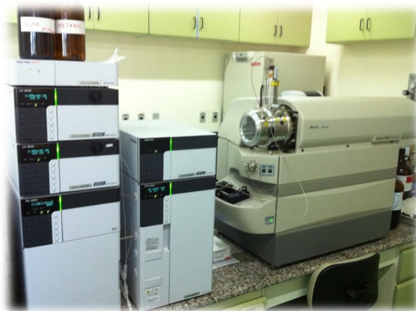
Figura 11. Cromatógrafo Líquido (Proeminence UFLC) acoplado ao espectrômetro de massas (3200 Q TRAP) LC-MS/MS. Botucatu/SP, 2013.
