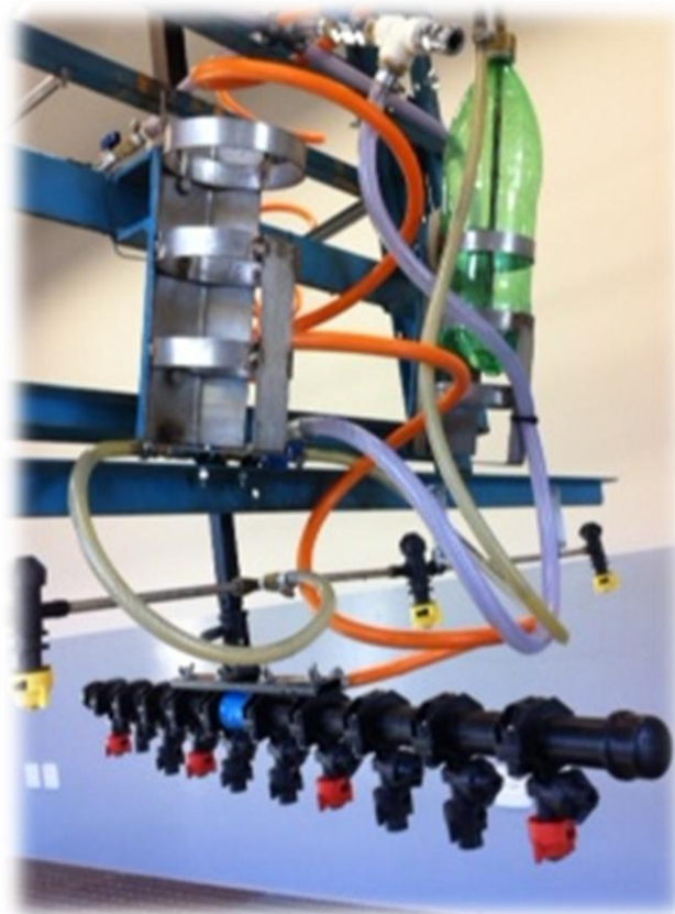
Figura 8. Equipamento de pulverização e simulação de chuva utilizados no experimento com dinâmica de herbicidas em palha de cana-de-açúcar. As pontas amarelas são de pulverização dos produtos e as vermelhas de simulação de chuva. Botucatu/SP, 2013.
