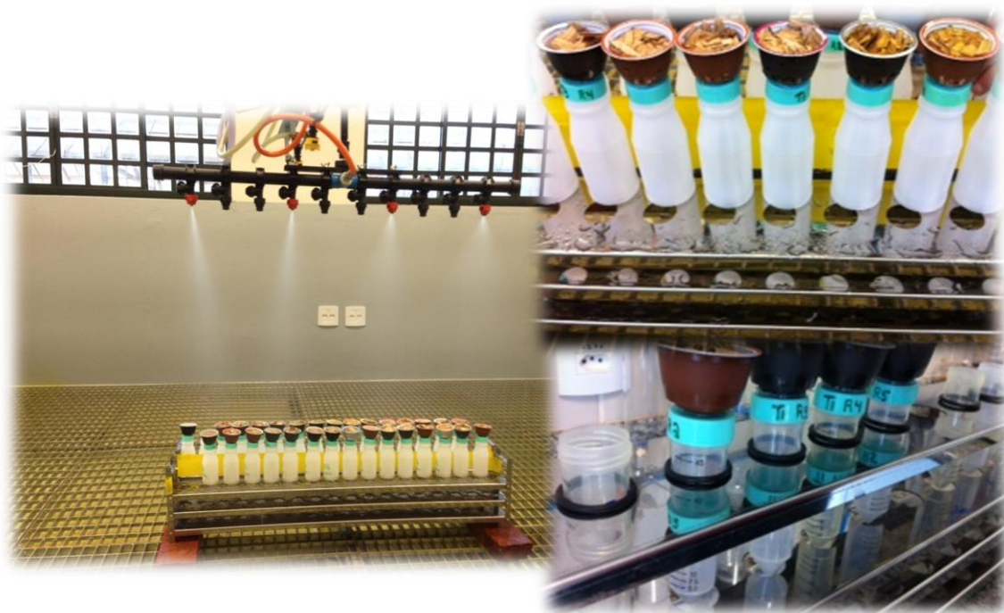
Figura 10. Simulação de diferentes lâminas de chuva no experimento com detalhe para os frascos utilizados na coleta da solução lixiviada da palha após a chuva simulada. Botucatu/SP, 2013.
