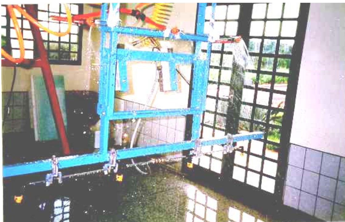
Figura 1. Equipamento com dupla barra utilizado para pulverização do herbicida isoxaflutole e simulação das precipitações. Núcleo de Pesquisas Avançadas em Matologia (NUPAM), FCA/UNESP, Botucatu, SP.
