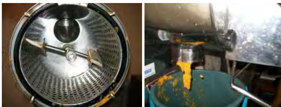
Figura 4. Despolpamento mecânico de endocarpos de S. mombin . Belém, Embrapa Amazônia Oriental, 2011. (Foto: Bárbara Quadros)
