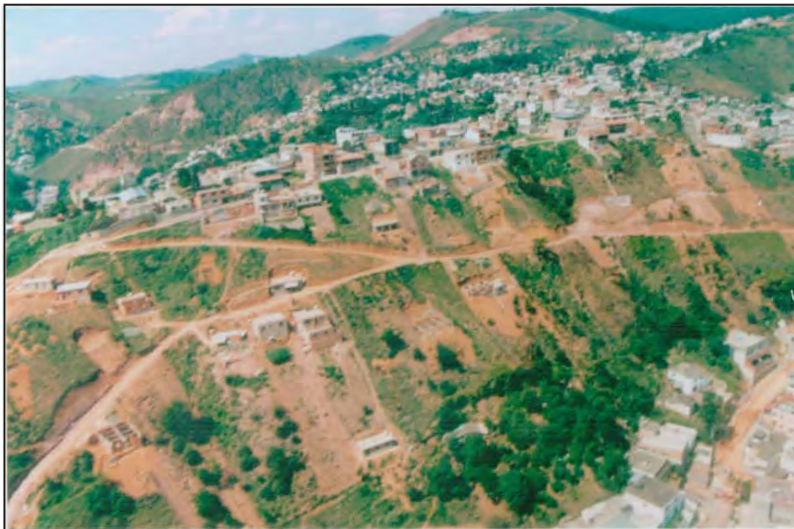
Fotografia 8: A - Ocupação em encosta de alta declividade; solo exposto; falta de infra-estrutura urbana. Bairro Cesário Alvim, Juiz de Fora (MG). Defesa Civil de Juiz de Fora, sem data.
