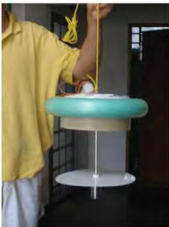
Figura 3. Câmara gasométrica Construmaq São Carlos
