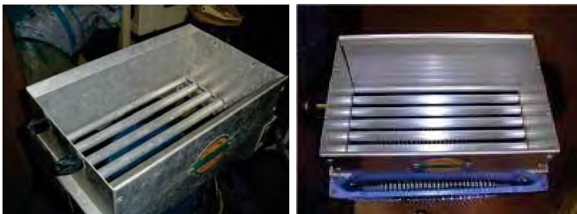
Figura 1. Caixa gradeadora mostrando em detalhes as barras paralelas ajustáveis.
