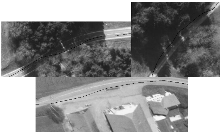
Figura 28 – Exemplo de problemas encontradas na extração do eixo no experimento mono
