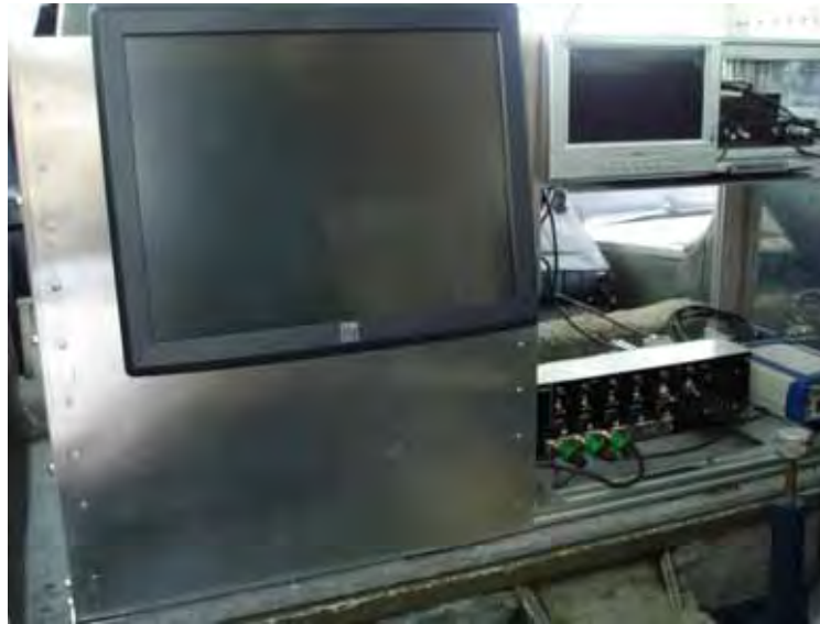
Figura 34: Unidade de controle e alimentação de energia do SAAPI.
