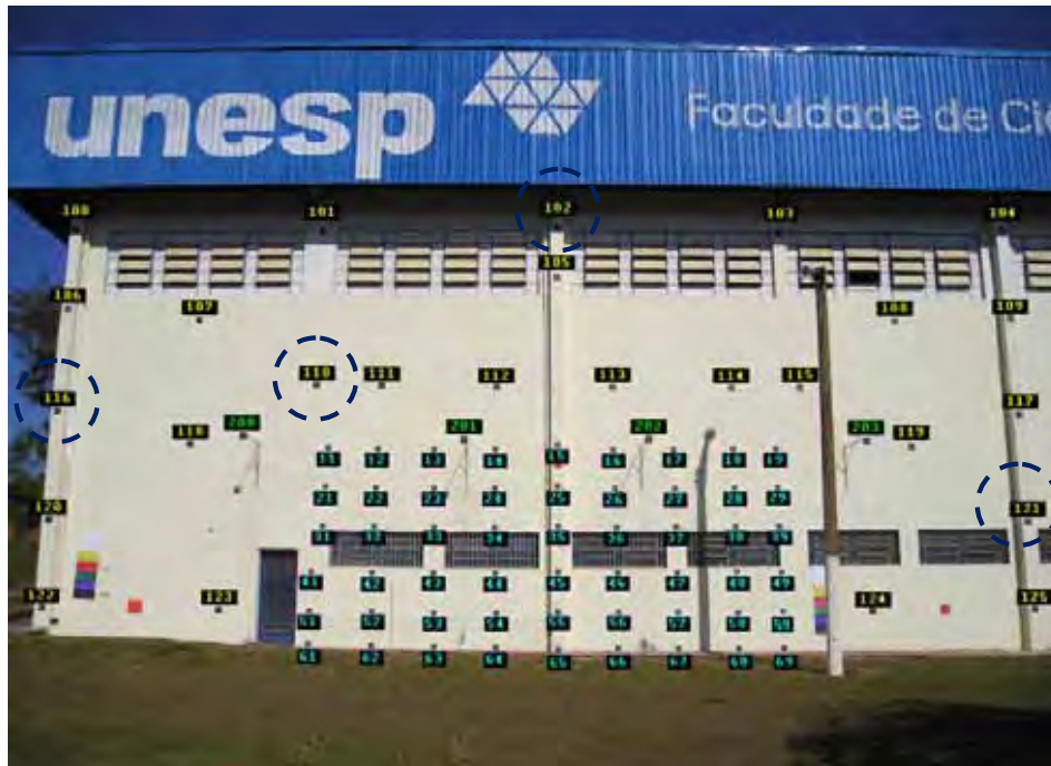
Figura 54: Distribuição dos pontos no campo de calibração da FCT/UNESP. Os pontos em destaque (circulados) correspondem aos pontos de verificação.
