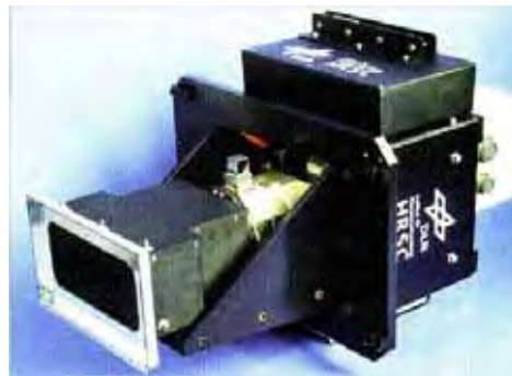
Figura 10: Câmara aérea digital HRSC-A (LEHMANN, 2000).
