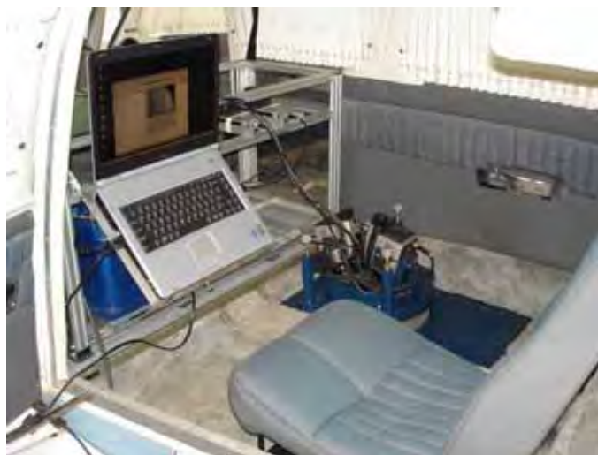
Figura 50: Sistema SAAPI instalado na aeronave para o voo teste sobre a rodovia Ayrton Senna, São José dos Campos - SP.
