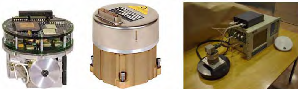
Figura 23: Unidade de medida inercial Litton LN-200 e processador de navegação (COLOMINA, 2002).
