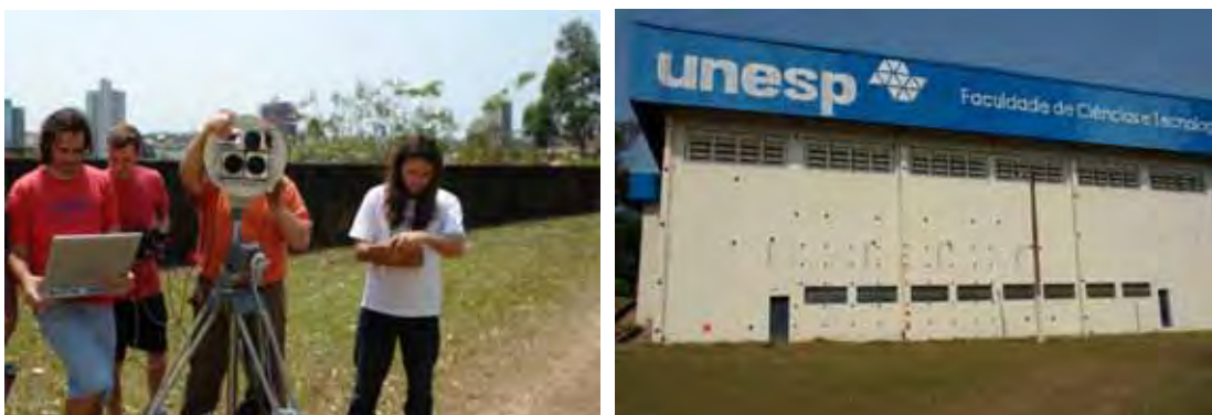
Figura 45: Calibração de câmaras: (a) coleta de imagens com a plataforma do sistema SAAPI, (b) campo de calibração da FCT/UNESP.
