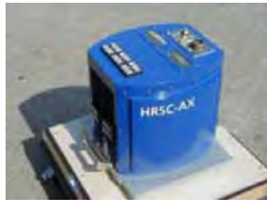
Figura 11: Câmara aérea digital HRSC-AX (POLI, 2003).
