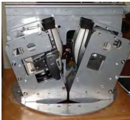
Figura 33: Plataforma de coleta do sistema SAAPL com os exoesqueletos de alumínio para as câmaras Hasselblad; (b) plataforma na configuração dual.
