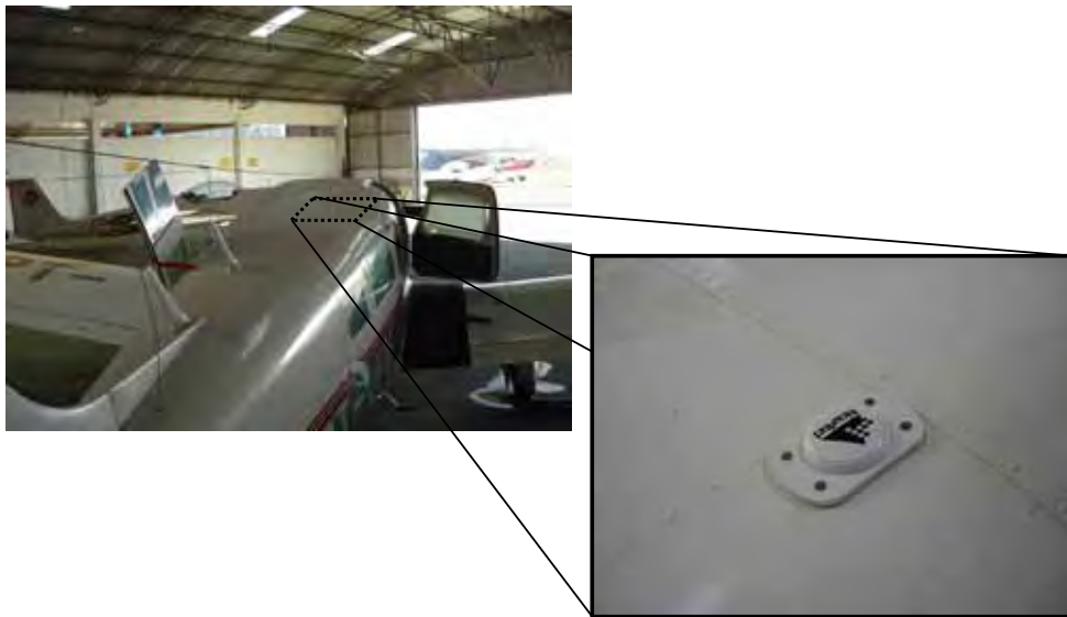
Figura 36: Antena Novatel GPS-534c fixada à aeronave.
