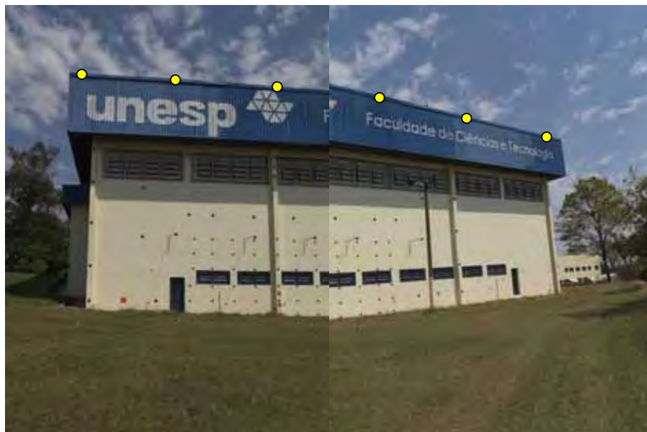
Figura 64: Cobertura obtida a partir de uma aquisição com a plataforma de coleta dual do sistema SAAP, com os novos alvos do campo de calibração da FCT/UNESP destacados na parte superior.
