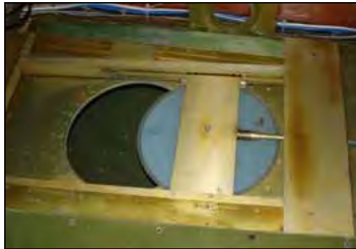
Figura 44: Sistema de escotilha desenvolvido para as operações com o sistema de coleta.
