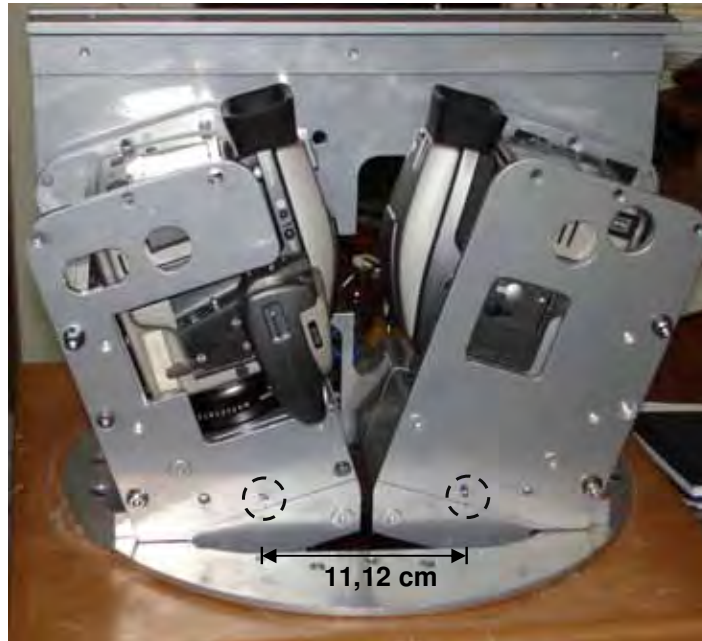
Figura 48: Medida de distância entre os centros perspectivos das câmaras na plataforma de coleta do sistema SAAPI.
