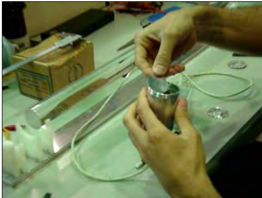
Figura 5.2 - Colocação do compósito no transdutor.
