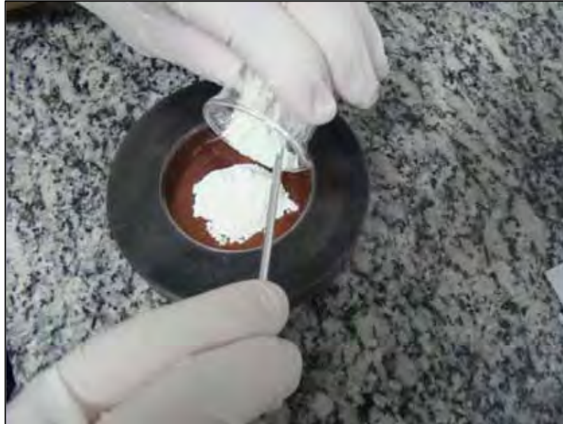
Figura 3.3 - Colocação da mistura de PZT/PVDF no molde.
