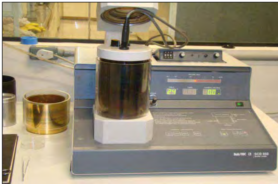
Figura 3.12 - Revestimento das amostras com carbono.
