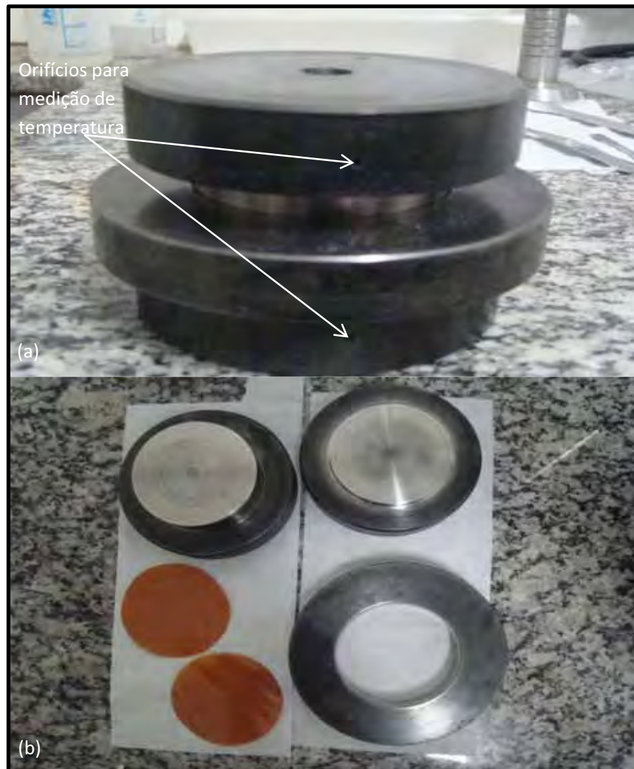
Figura 3.1 - Fotos do molde. (a) Molde montado e fechado. (b) Molde desmontado.
