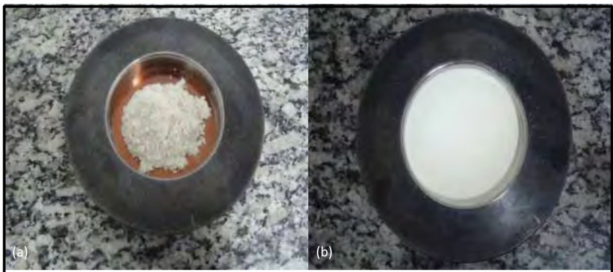
Figura 3.4 - Mistura de PZT/PVDF. (a) Pó no molde. (b) Pó uniforme no molde.
