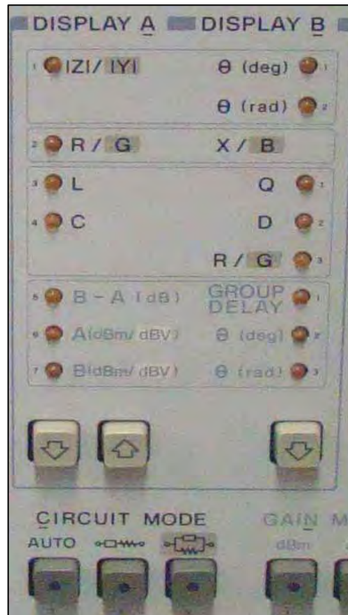
Figura 4.6 – Configuração utilizada para medição de admitância (selecionando-se as opções |Y| , G , B e circuit mode 3 no painel do medidor).
