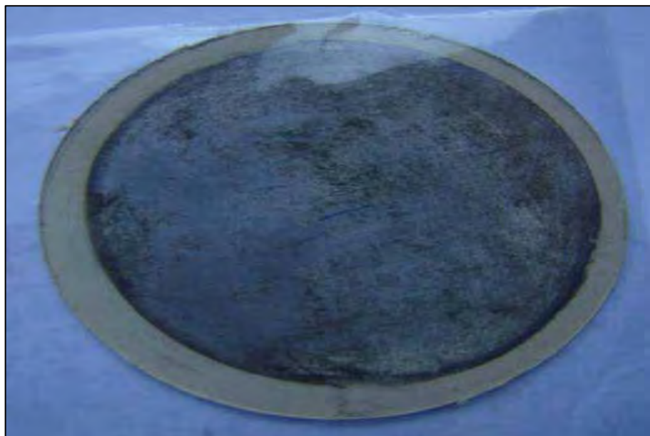
Figura 3.9 - Compósito metalizado e polarizado.
