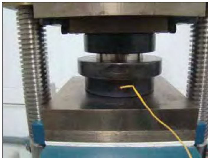
Figura 3.5 - Fabricação do compósito na prensa quente.
