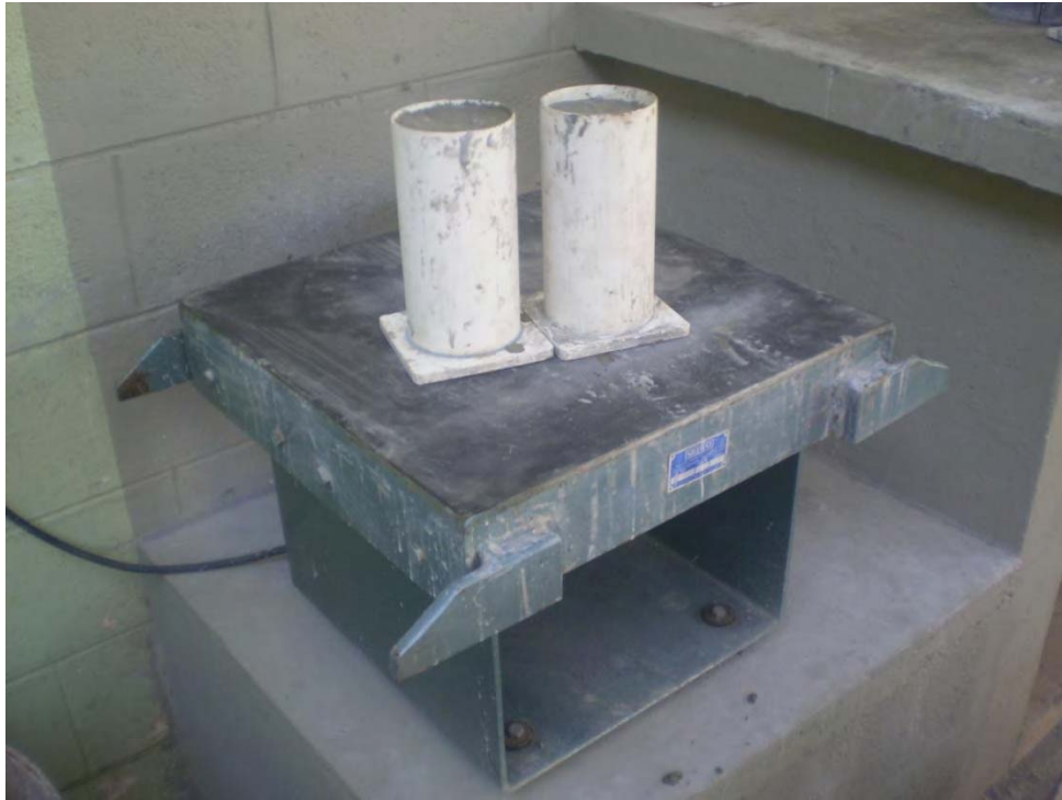
Figura 4-3-2: Adensamento dos corpos de prova em mesa vibratória.
