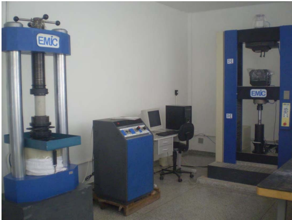
Figura 4-3-3: Prensas EMIC PC 200 e DL 30000. Laboratório do DEC–UNESP-Campus de Ilha Solteira.
