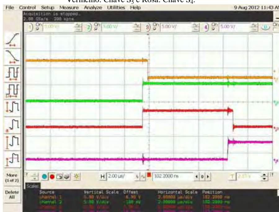
Figura 142 - Pulsos de gate para o acionamento das chaves do inversor. Amarelo: Chave S_p ; Verde: Chave S_1 ; Vermelho: Chave S_5 e Rosa: Chave S_4 .
