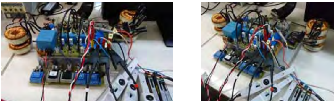
Figura 158 - Detalhe da implementação experimental. Detalhe para o sistema de medição no ponto de conexão com a rede elétrica.
