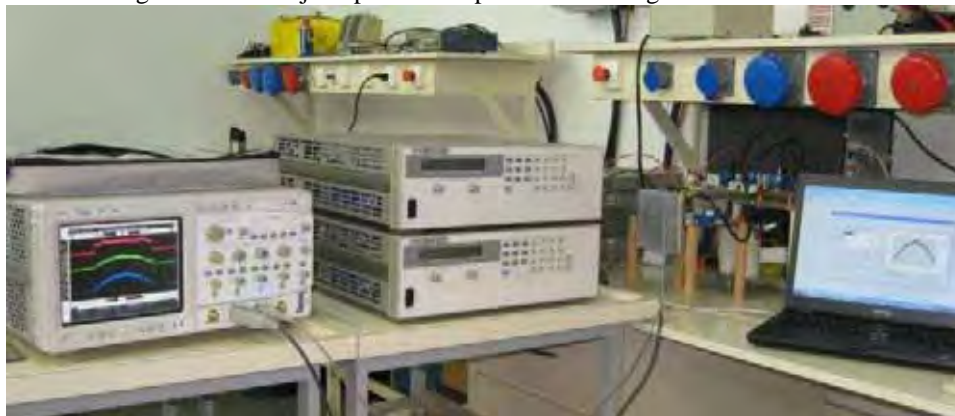
Figura 24 - Arranjo experimental para teste dos algoritmos de MPPT.
