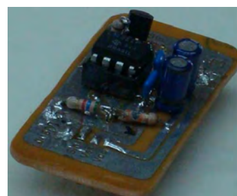
Figura 4.14: Placa de Condicionamento para o circuito de interface de acionamento do contator de entrada.
