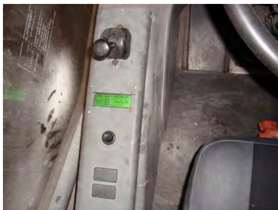
Figura 5.16: Display de LCD com quatro linhas e vinte posições por linha.
