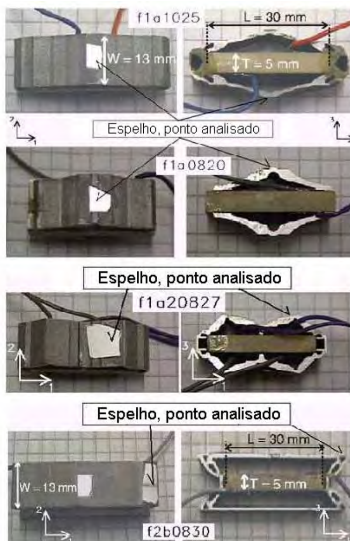
Figura 2.7 – Piezoatuadores flexensionais com diferentes topologias, dependendo do ponto em que se deseja amplificar a vibração [143].
