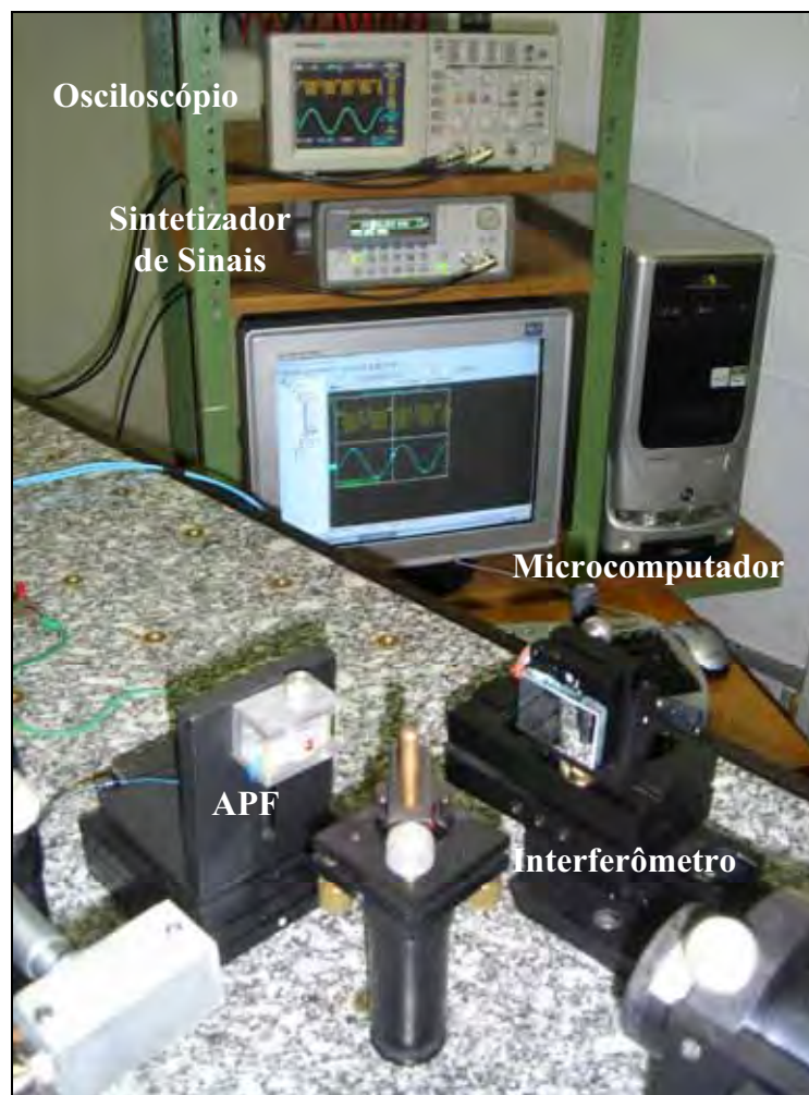
Figura 8.4 – Montagem experimental para caracterização do APF, composto basicamente pelo interferômetro de Michelson, o sintetizador de sinais Agilent 33220A, o osciloscópio digital Tektronix TDS2022 e o microcomputador para aquisição e processamento digital da tensão fotodectada.
