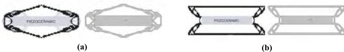
Figura 2.6 - Resultados de otimização topológica e a interpretação correspondente [155]. a) Deslocamento máximo no centro do encapsulamento metálico. b) Deslocamento máximo na extremidade do encapsulamento.
