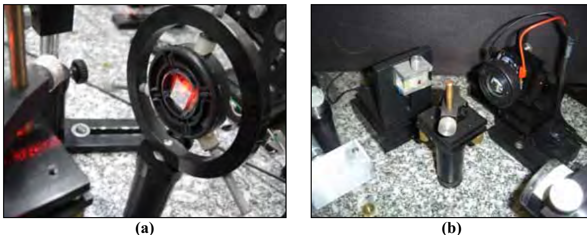
Figura 8.16 – (a) Detalhe do tweeter usado no interferômetro para uso específico dos métodos J_0\dots J_2 e J_0\dots J_3 . (b) Interferômetro de Michelson modificado em seu braço de referência, pelo uso do tweeter .
