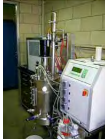
Figura 6: Fermentador Biostat Sartorius utilizado para obtenção das culturas de bactérias.
