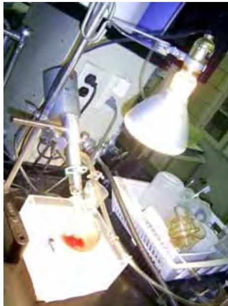
Figura 8: Amostra de Hb sendo oxigenada em um rotovapor, dentro de um recipiente com gelo e iluminada por uma lâmpada de 120W.
