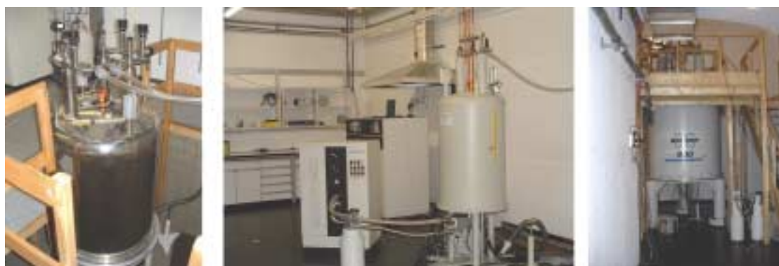
Figura 3.2 –Fotos de três dos equipamentos utilizados para a coleta de dados de RMN. À esquerda, magneto supercondutor do espectrômetro DRX 750, no centro consoles e magneto do espectrômetro DRX-500 e à direita, magneto supercondutor do espectrômetro AVANCE-900.
