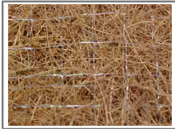
Figura I – Detalhe da estrutura da Tela Fibrax 400BF, onde é possível verificar a fibra de coco fixa por intermédio das linhas de polipropileno.
