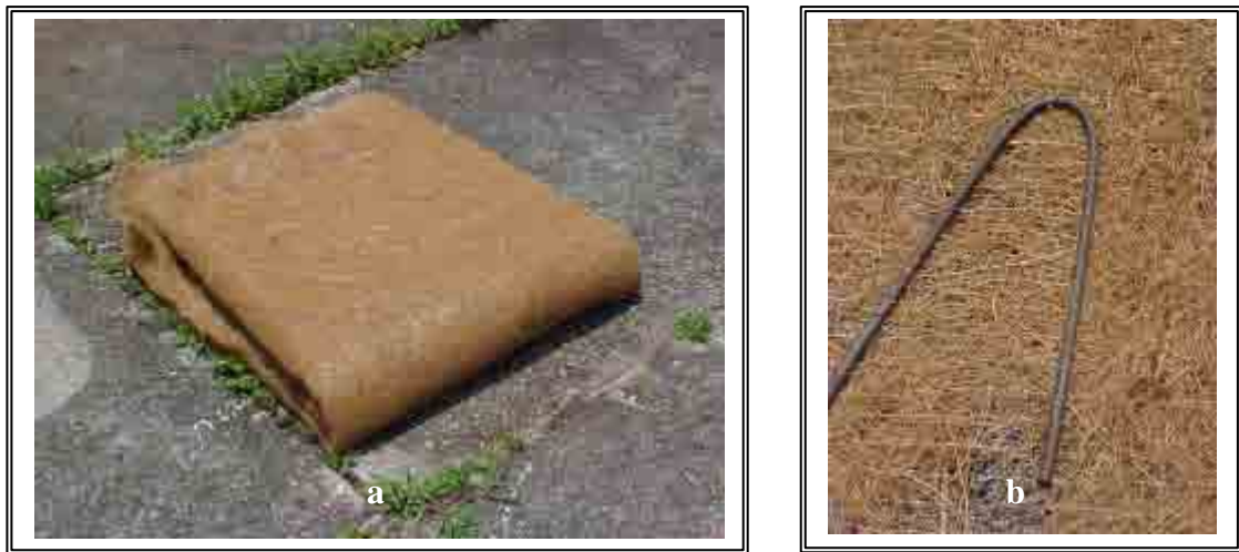
Figura IIIa e IIIb – Forma pela qual as mantas foram levadas ao campo (a) e ganchos utilizados na fixação (b).
