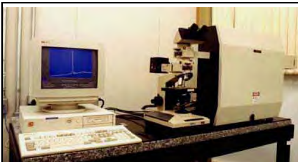
FIGURA 5 - Equipamento Raman fabricado pela Renishaw, modelo 2000, equipado com laser de argônio com 514,5nm de comprimento de onda.
