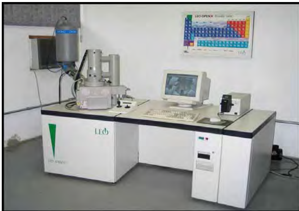
FIGURA 4 - Microscópio Eletrônico de Varredura (MEV) acoplado a um analisador de espectroscopia por espalhamento de energia dispersiva dos raios X (EDS).
