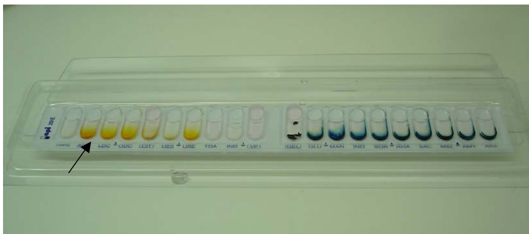
FIGURA 11 – Galeria de API 20E contendo 20 mini-testes bioquímicos utilizada para identificação de enterobactérias e bactérias do gênero Pseudomonas . Observa-se os microtubos contendo os substratos desidratados (seta).
