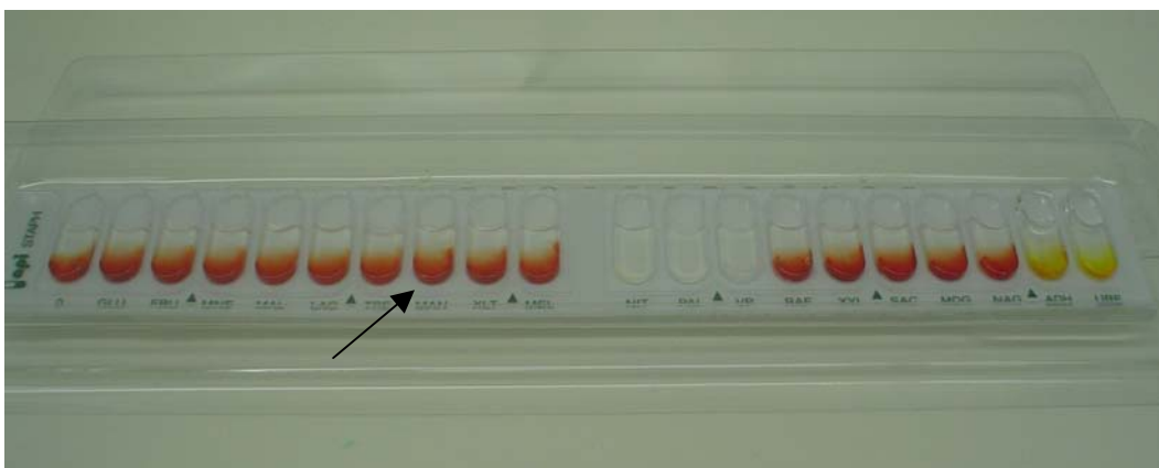
FIGURA 6 - Galeria de API Staph contendo mini-testes bioquímicos utilizada para identificação de estafilococos coagulase-negativa. Observa-se os microtubos contendo os substratos desidratados (seta).
