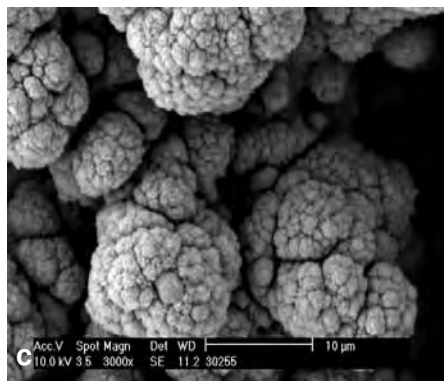
Figura 8: Morfologia da superfície da amostra 7 após a irradiação laser e seus respectivos aumentos: a) 500x, b) 1000x, c) 3000x e d) 5000x.
