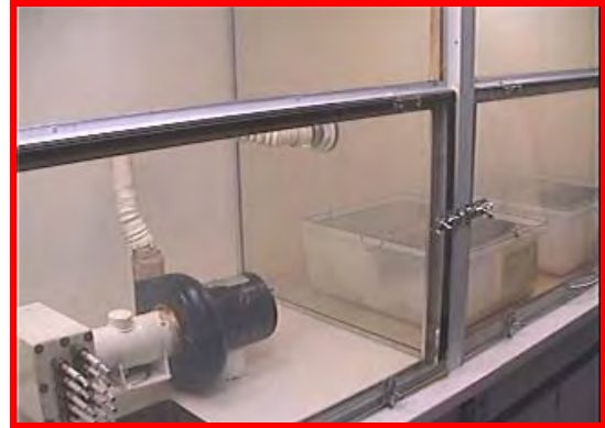
Figura 2 - Câmara de Contenção
