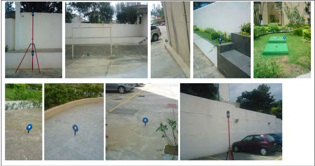
Figura 44 - Distribuição dos pontos de controle pela região do edifício
