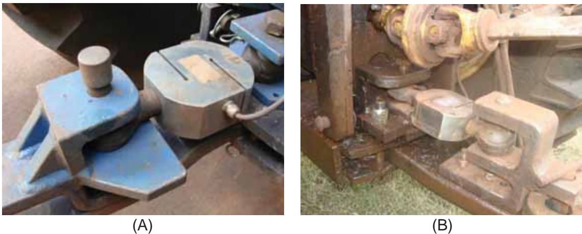
Figura 9. Célula de carga Shimizu TF 400 montada sobre o berço no primeiro (A) e no segundo (B) ano agrícola.
