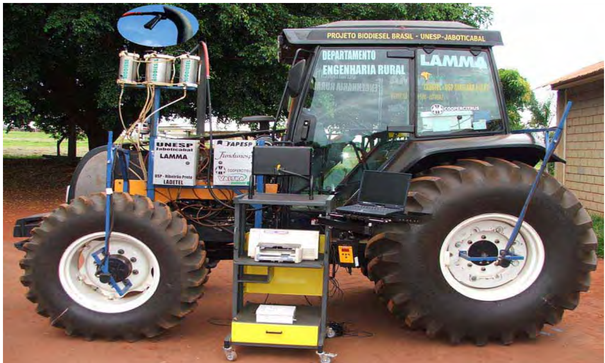
FIGURA 10. Vista geral do trator instrumentado para o ensaio de opacidade da fumaça. Fonte: LOPES (2006).
