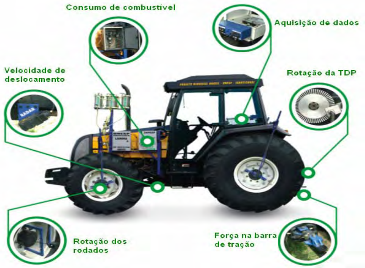
FIGURA 8. Vista lateral do trator de teste com instrumentação completa.
