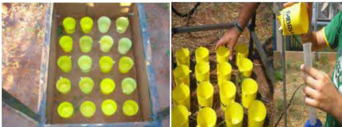
FIGURA 9. Realização do CUC em parcela a ser submetida à simulação de chuva.
