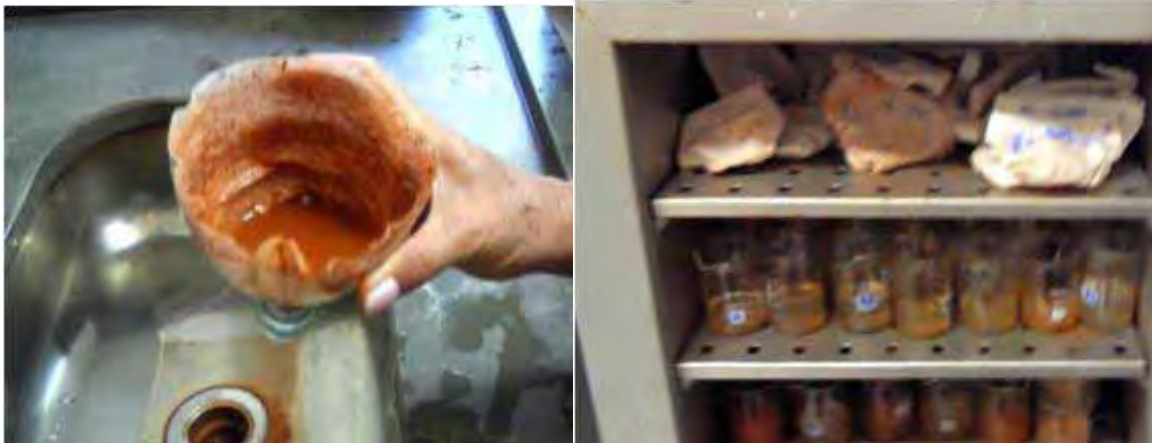
FIGURA 10. Filtragem e secagem do material coletado em estufa.
