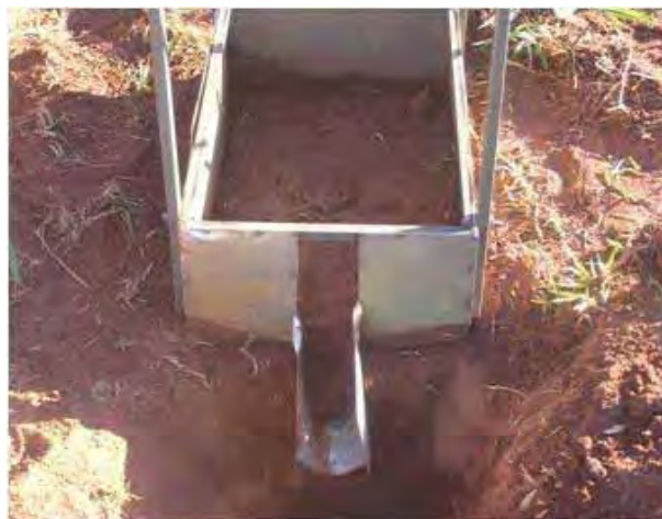
FIGURA 8. Calha coletora instalada na parte inferior do simulador de chuva.
