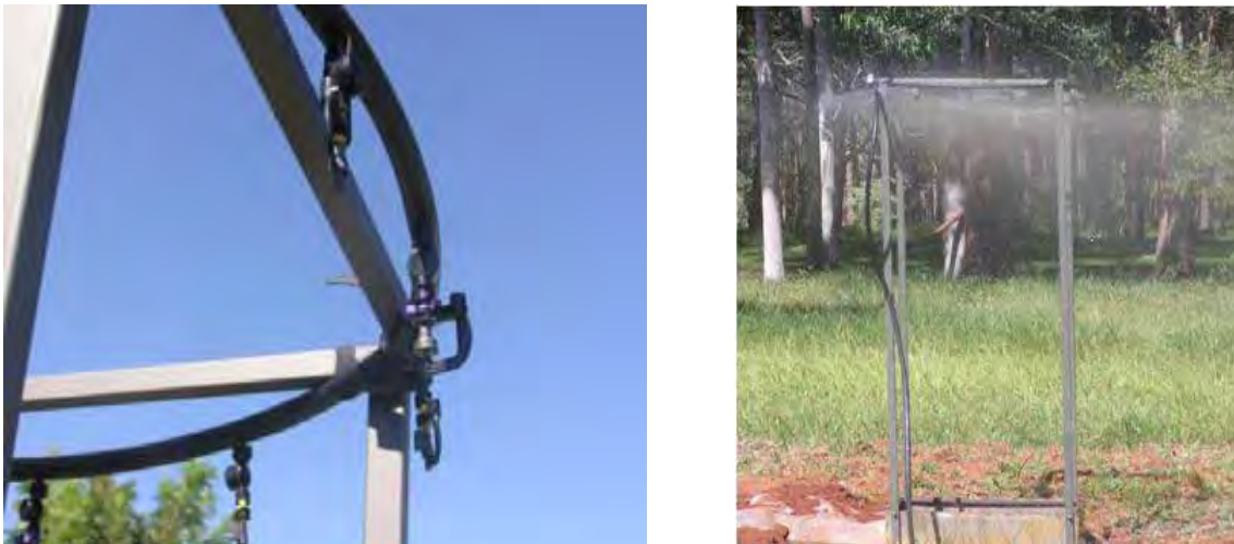
FIGURA 7. Detalhe dos aspersores e do simulador em operação.
