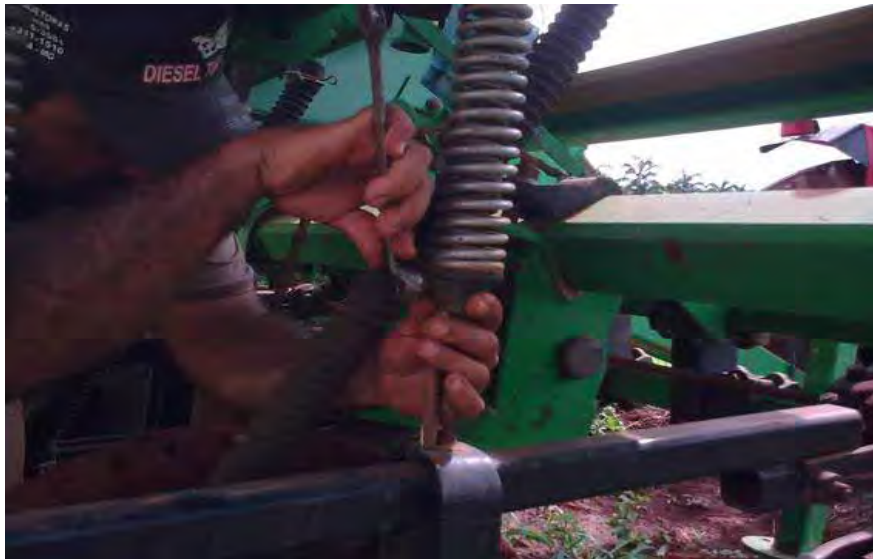
Figura 4. Aferição da profundidade de deposição do adubo por ocasião do plantio do milho
