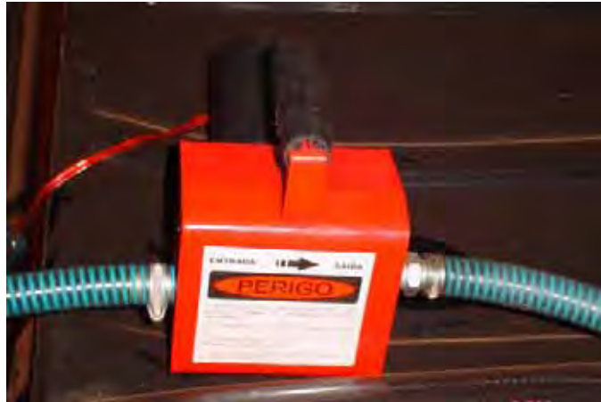
FIGURA 2. Bomba de abastecimento.
