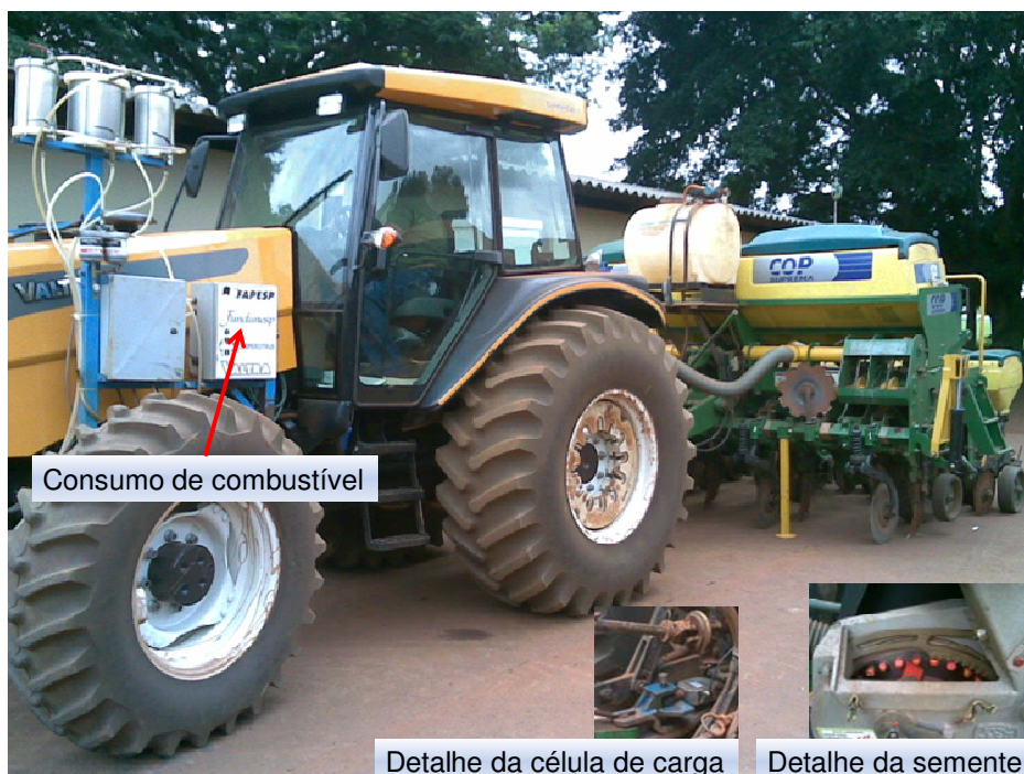
Figura 2. Trator e semeadora com o equipamento de medição de combustível, célula de carga e detalhes das sementes utilizadas.
