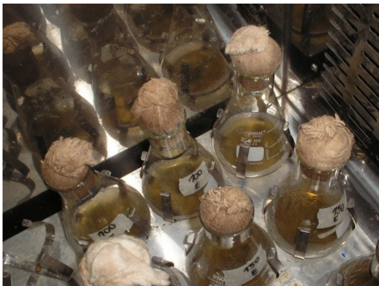
Fotografia 4. Caldo de fermentação durante incubação a 30°C e 200 rpm em “shaker” rotativo.
