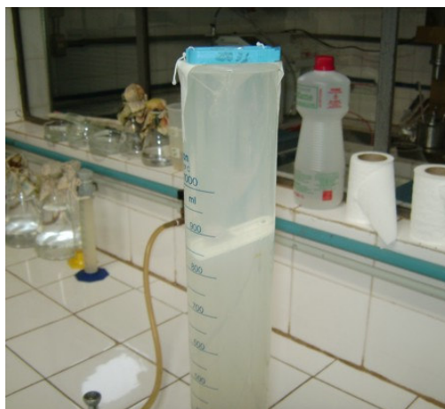
Fotografia 8. Diálise para a purificação do biossurfactante.
