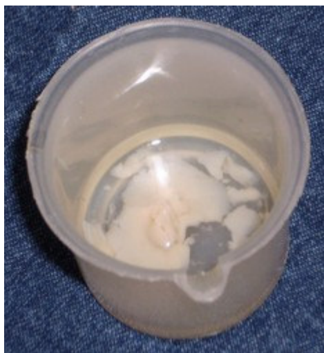
Fotografia 7. Biossurfactante obtido por precipitação com etanol a 4°C.
