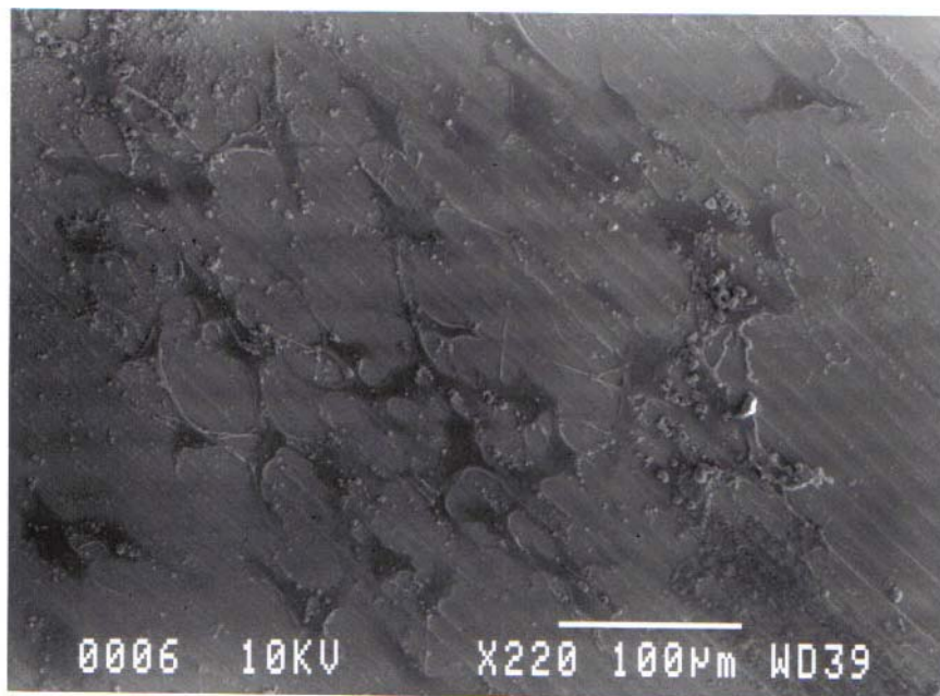
Figura 27 – Morfologia das células VERO crescendo sobre amostra da liga TNZ na condição após quarta dopagem.
