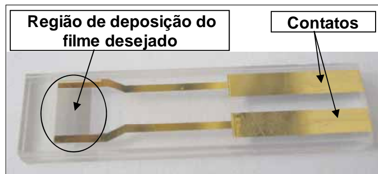
Figura 3.5. Capacitor interdigitado: trilhas condutoras de Au sobre as quais são depositados os filmes e indicação dos contatos elétricos.
