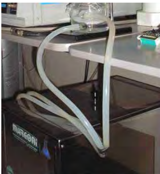
Figura 3.11. Foto do banho termostatizado MA-184, MARCONI- mostrando célula de vidro.
