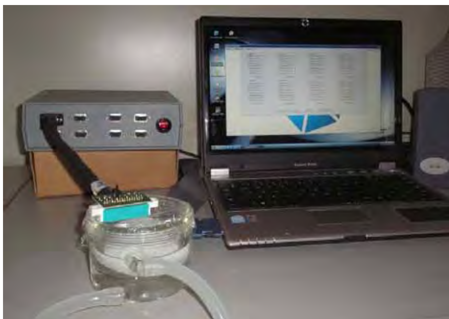
Figura 3.7. Fotografia do aparelho para as medidas com a “língua eletrônica”.
