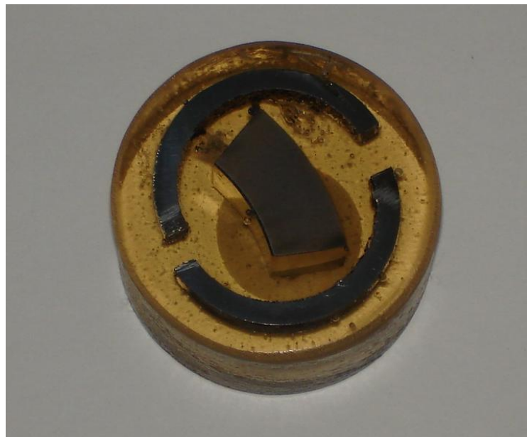
Figura 3.37 – Embutimento destinado à análise de MEV e microdureza.
