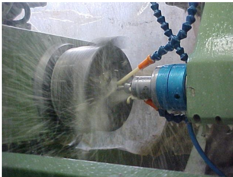
Figura 3.27 – Operação de retificação interna empregando-se a técnica convencional de lubri-refrigeração.
