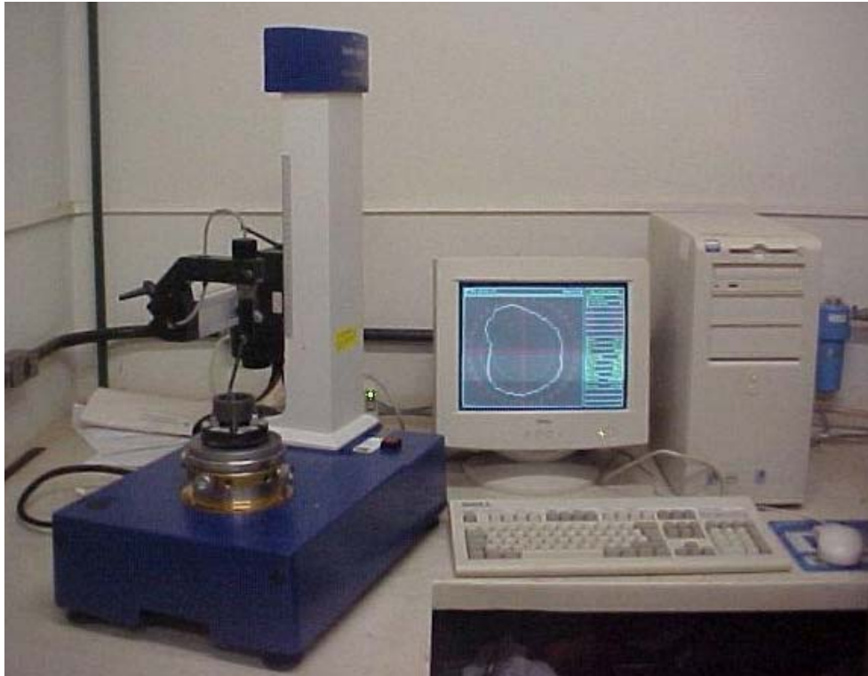
Figura 3.33 – Aparelho TALYROND 31 C, Taylor Robson utilizado para medição dos desvios de circularidade.
