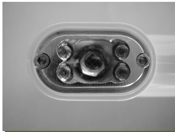
FIGURA 8 B - Detalhe dos cinco emissores Leds APARELHO Ultra Lume Led 5
