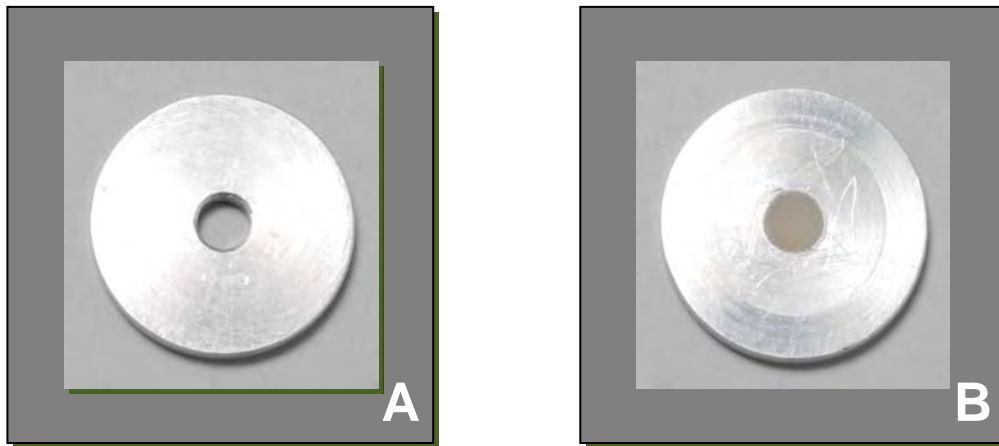
FIGURA 11- A - matriz circular de alumínio com perfuração central B - resina composta para obtenção do corpo-de-prova
