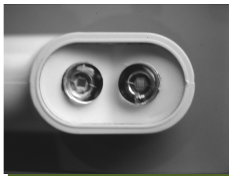
FIGURA 7 B - Detalhe dos dois emissores Leds dirigidos APARELHO Ultra Lume Led 2
