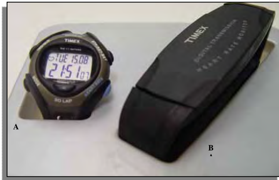
FIGURA 4. Frequencímetro. (A) Relógio receptor que capta o ritmo cardíaco enviado pelo sensor. (B) Cinta com sensor que fica encostado no peito da criança.
