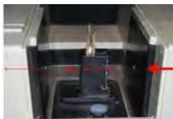
FIGURA 5. Visão Interna do espectrofotômetro com a amostra sendo posicionada no anteparo específico do aparelho.
