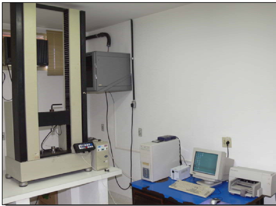
Figura 11. Aparelho utilizado para medida da força de ruptura.
