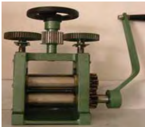
Fig. 15 - Cilindros de precisão ajustáveis utilizados para a realização da “clivagem” das corticais internas e externas da calvária
