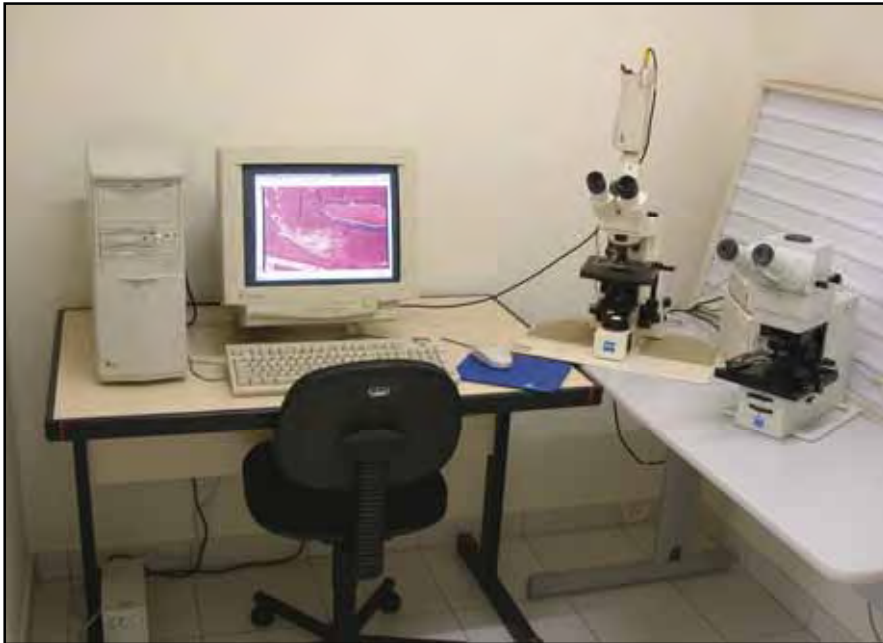
Fig. 1 - Equipamento utilizado na captação das imagens histológicas. Câmera digital (JVC TK-1270 Color Vídeo Câmera) acoplada ao microscópio Carl Zeiss (AxioLab) e conectada ao computador.
