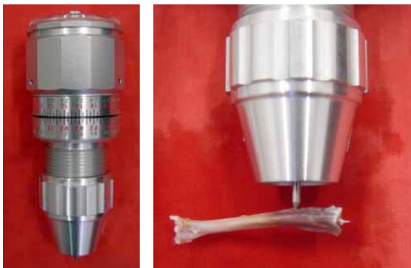
Figura 3 – Torquímetro utilizado para realização do teste de torque reverso.
