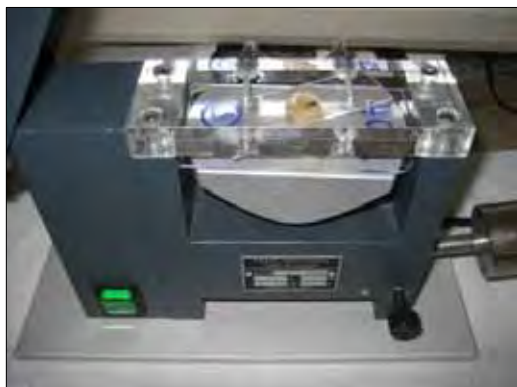
Fig. 19 – Adesão do corpo de prova na lâmina no aparelho do Sistema Exakt®.
