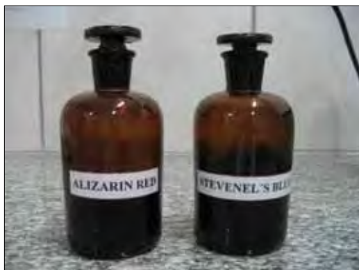
Fig. 21 – Corantes VA/AS utilizados na coloração das lâminas cortadas pelo Sistema Exakt®.
