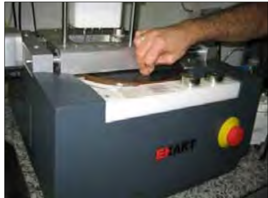
Fig. 18 – Desgaste da peça incluída em resina em aparelho abrasivo Exakt®.
