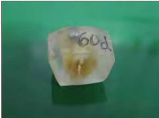
Fig. 17 – Bloco ósseo (tibia) contendo o implante incluído em resina Metil Metacrilato.
