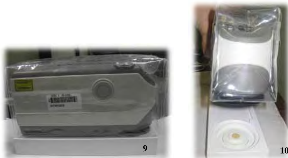
FIGURAS 9 e 10 - Vista lateral e frontal do colorímetro Minolta (CM 2600d, Japão).
