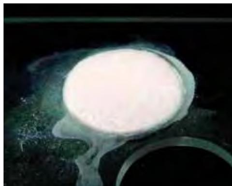
FIGURA 22 - Cerâmica condensada na matriz.
