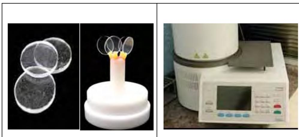
FIGURA 10 - Discos fixados no *sprue*.
