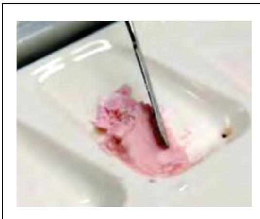
FIGURA 21 - Mistura da cerâmica de cobertura.
