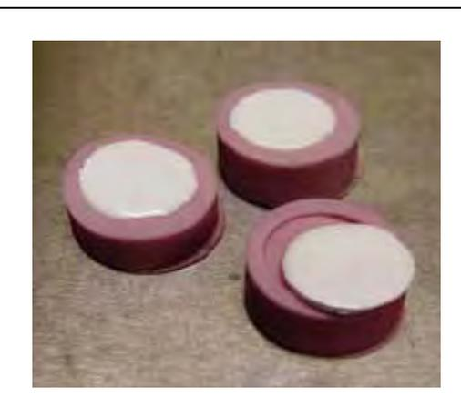
FIGURA 5 - Remoção da cerâmica da matriz.
