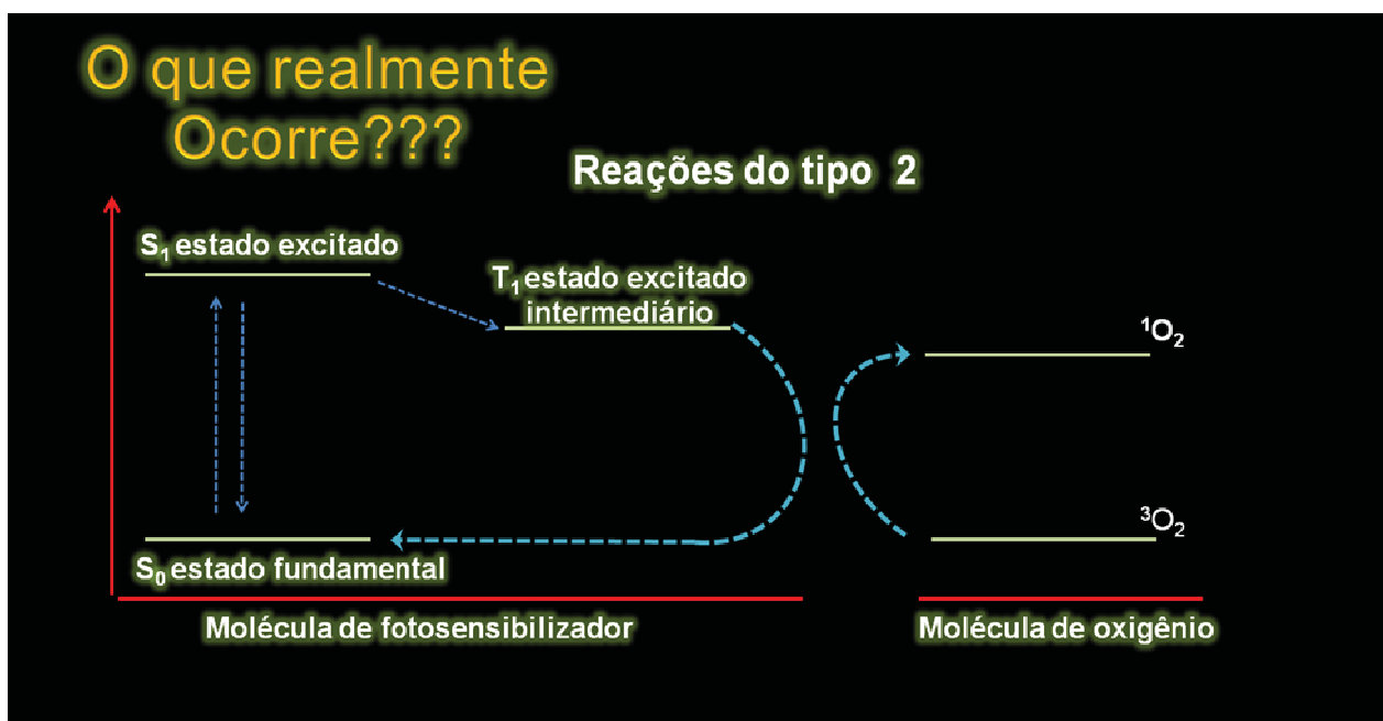
FIGURA 2. Desenho esquemático que representa o processo de geração do oxigênio singlete. Reações do tipo 2.
