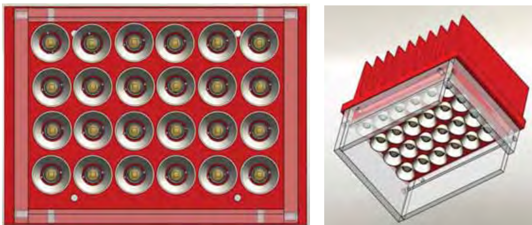
FIGURA 5. Desenho esquemático do dispositivo de irradiação da placa de 24 poços (Direitos de imagem reservados ao LAT- Laboratório de apoio Tecnológico – IFSC/ USP).
