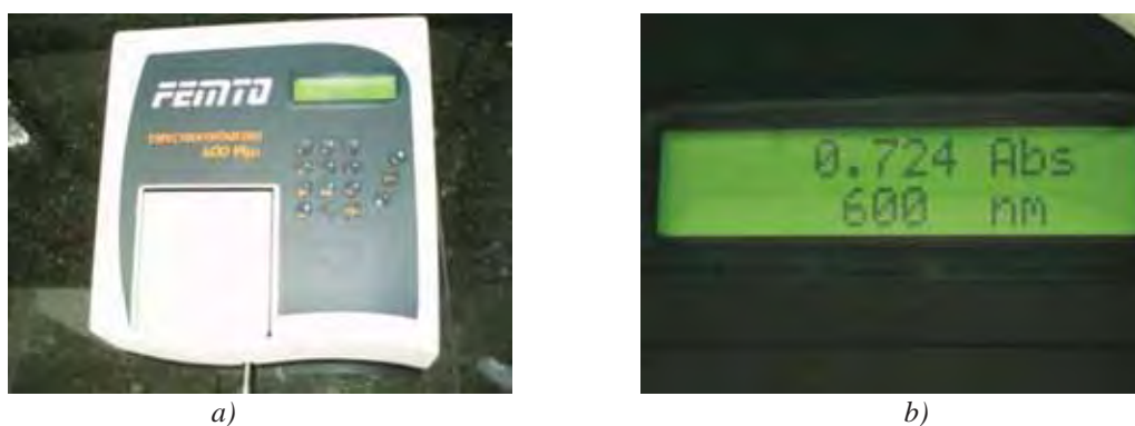
FIGURA 1. a) Espectrofotômetro que será utilizado para avaliar e normalizar a quantidade da população inicial de microrganismo; b) Detalhe do display do equipamento evidenciando o comprimento de onda que será utilizado e o valor do coeficiente de absorção.
