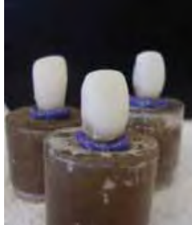
FIGURA13: Confeção do ligamento periodontal antes do corte dos excessos do poliéter
