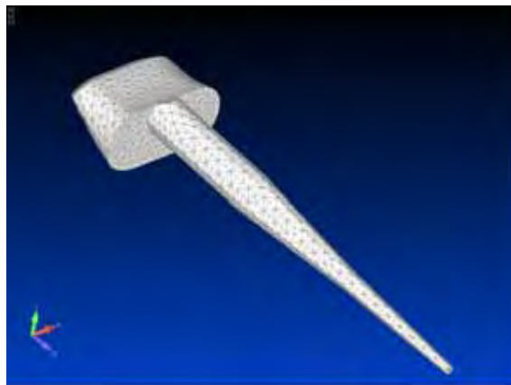
FIGURA 25: Malha do núcleo metálico.
