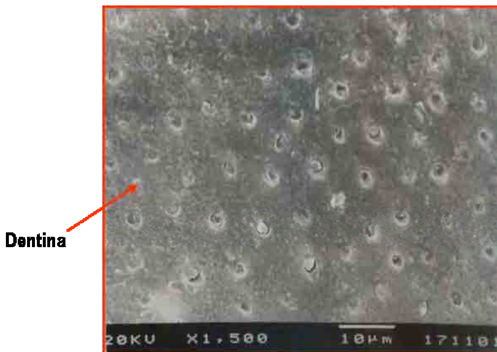
Figura 25. Aspecto da fratura adesiva, no espécime G3D4(5) (porção dentina), sob MEV com aumento de 1500X.
