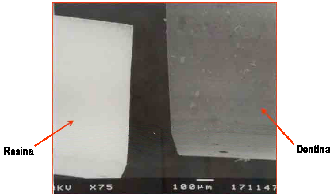
Figura 22. Aspecto da fratura adesiva, no espécime G3D4(6), sob MEV com aumento de 75X.
