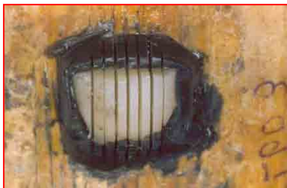
Figura 9. Amostra sendo cortada no sentido VL.
