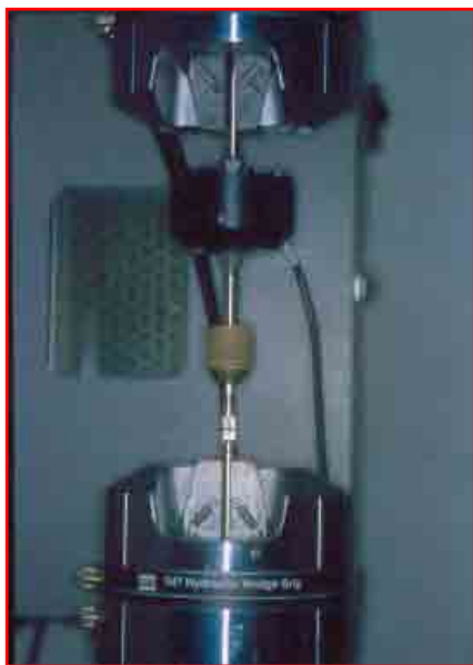
Figura 13. Dispositivo de microtração acoplado à máquina de ensaios mecânicos.
