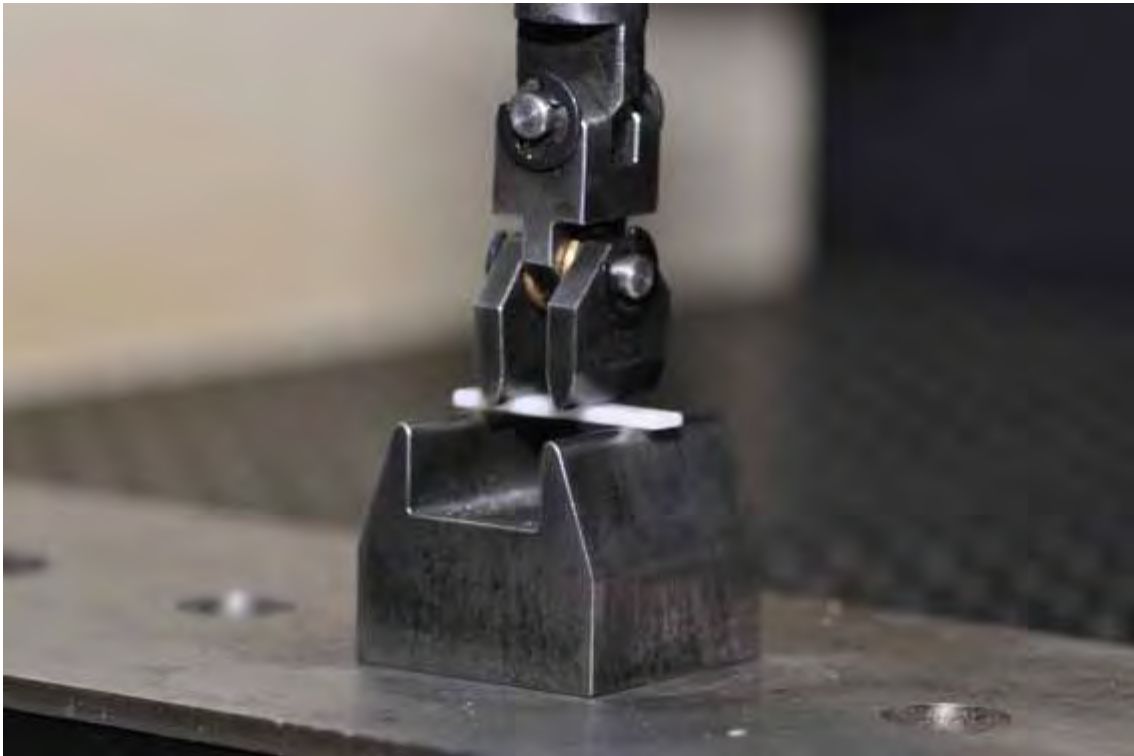
Figura 1 – Corpo-de-prova sendo submetido a ensaio de flexão a quatro pontos.
