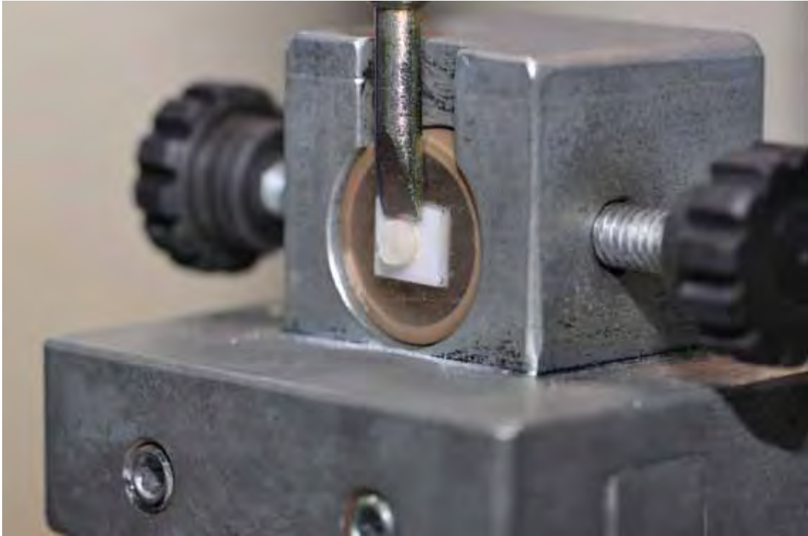
Figura 1 - Corpo-de-prova sendo submetido a ensaio de resistência de união.
