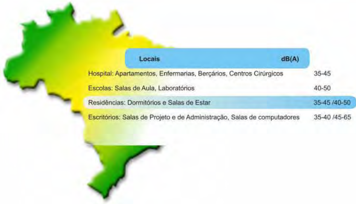
FIGURA 24 – Limites toleráveis relação local/nível (NBR 10152)
