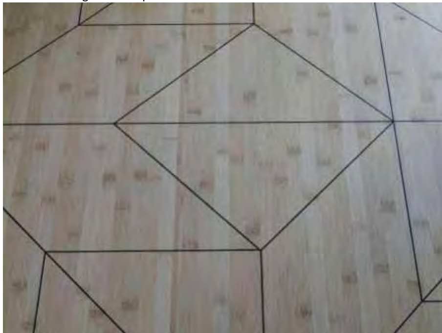
Figura 62: Impressão a laser sobre o laminado de bambu.
